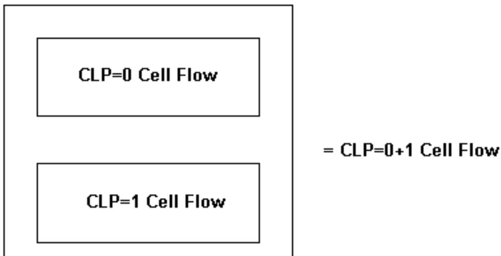
O fluxo de célula CLP=0+1 é chamado de fluxo agregado e inclui células CLP=0 e CLP=1.
