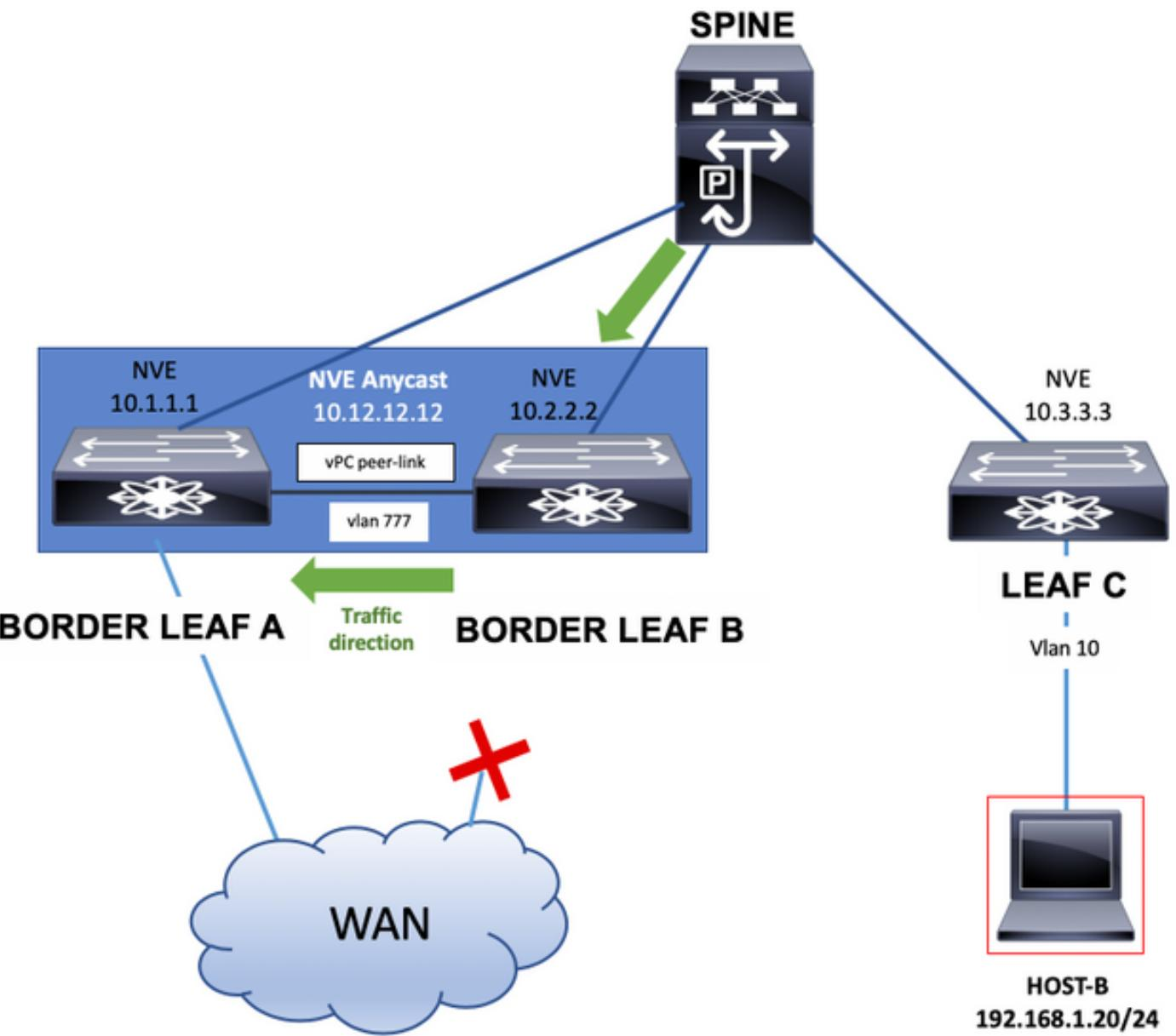
Border Leaf Switches kunnen ook interfacekaarten via de vPC peer-link adverteren met het gebruik van Static Routes of een Routing Protocol dat in een Tenant-VRF wordt geconcretiseerd. Dit verkeer wordt ook via de vPC peer-link overgedragen.
