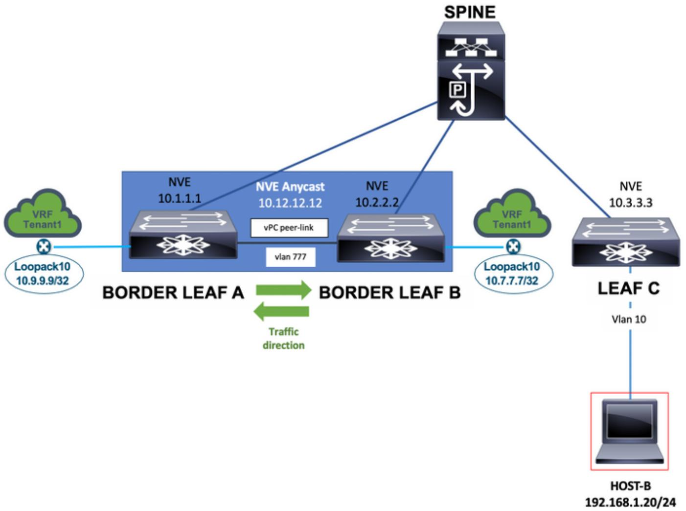
Tenslotte kunnen externe routers die zijn aangesloten op Border Leaf-switches netwerkprefixes adverteren die kunnen worden vereist om de vPC peer-link in het pad van het netwerkverkeer te hebben zoals in het volgende diagram wordt gezien.
