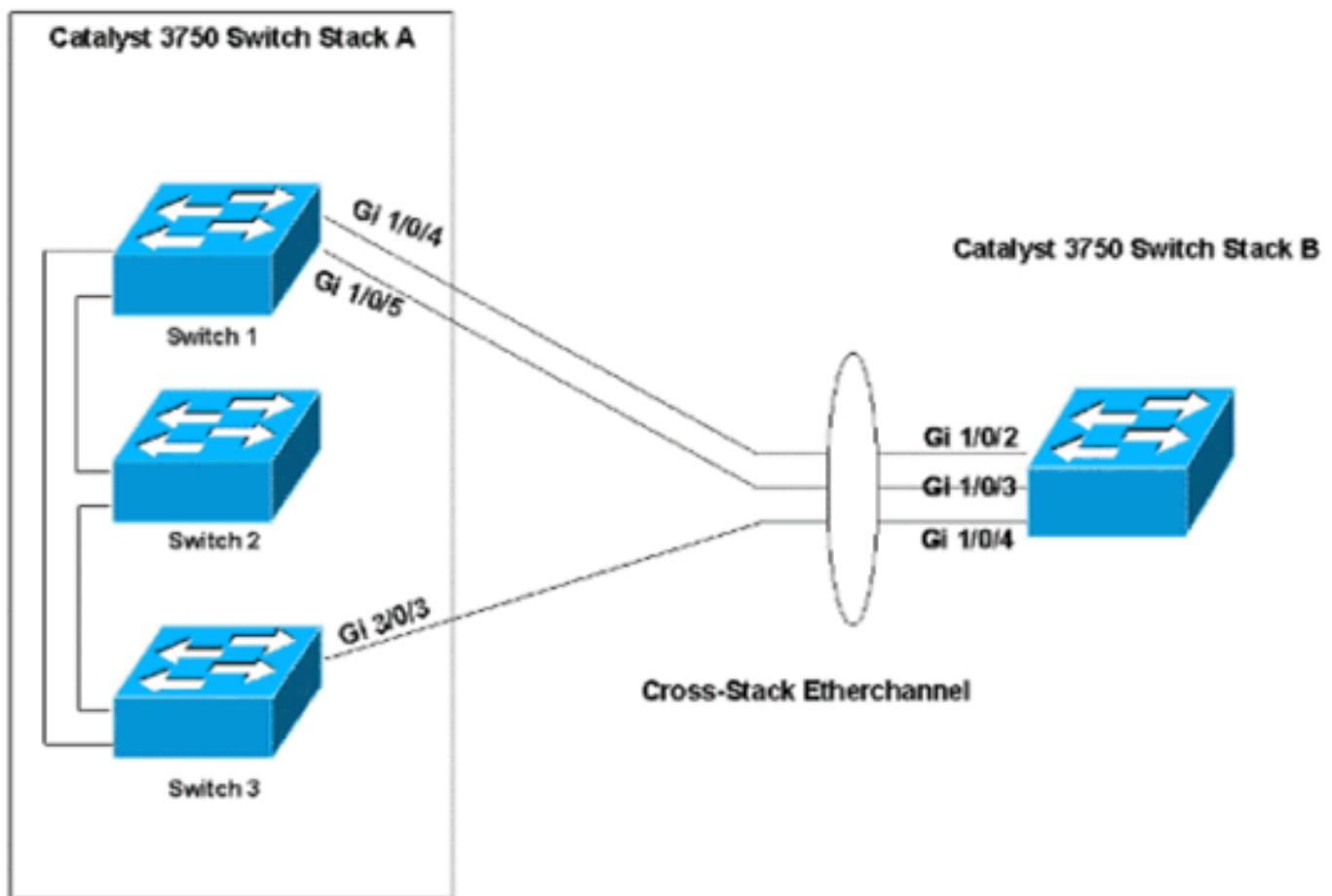
In dit netwerkdiagram zijn er twee Catalyst 3750 Switch stapels, Stack A en Stack B. Stack A heeft drie switch leden en Stack B heeft slechts één switch lid. EtherChannel wordt gevormd met twee poorten op Switch 1 en één poort op Switch 3 van Stack A. Deze poorten verbinden met de drie poorten in Stack B.
