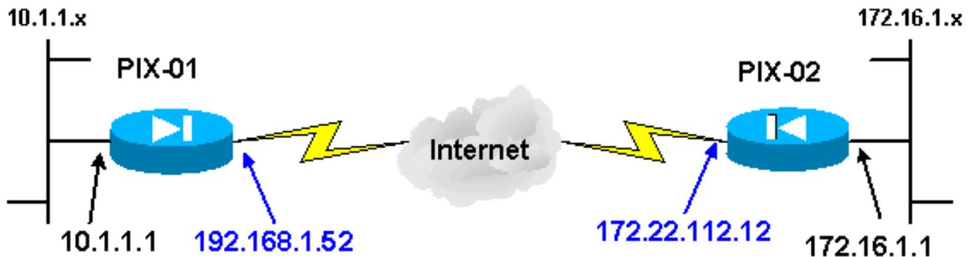
**Opmerking:** de IP-adresseringsschema's die in deze configuratie worden gebruikt, zijn niet wettelijk routeerbaar op het internet. Dit zijn [RFC 1918](#) adressen die in een labomgeving gebruikt zijn.
