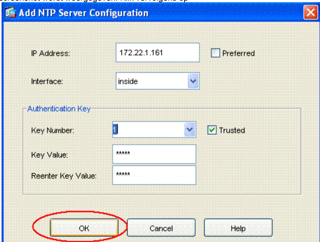
**Opmerking:** De interfacenaam dient voor ASA1 en daarbuiten voor ASA2 te worden gekozen. **Opmerking:** de NTP-verificatiesleutel dient dezelfde te zijn in ASA en de NTP-server. De configuratie van de autorisatieeigenschap in cli voor ASA1 en ASA2 wordt hierna weergegeven:
