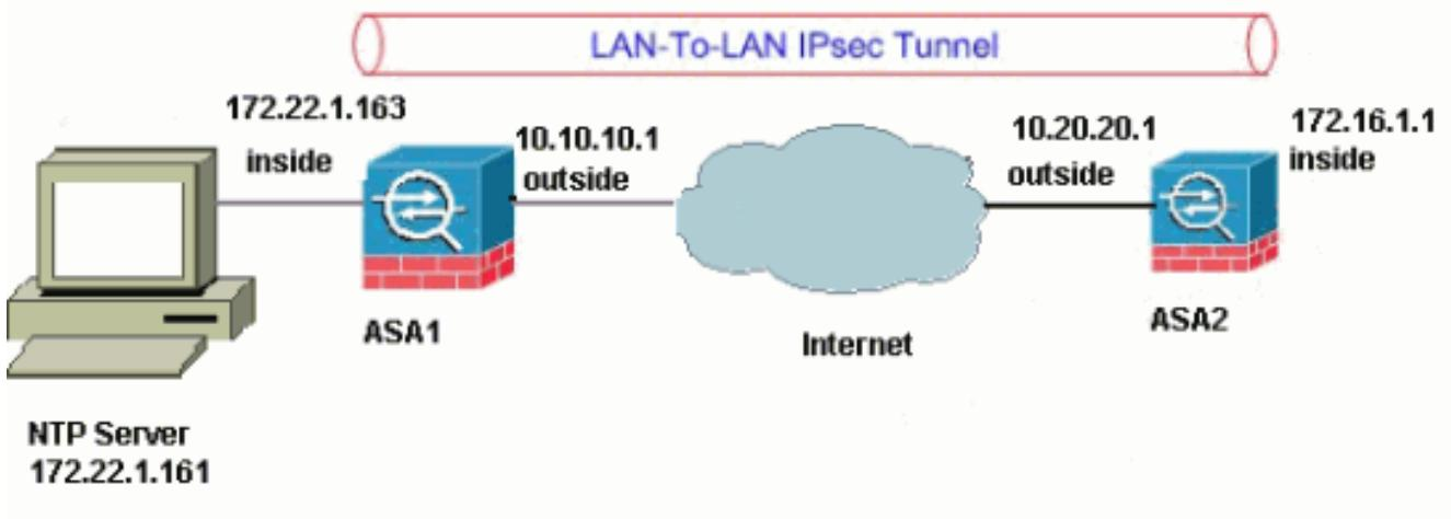
**Opmerking:** de IP-adresseringsschema's die in deze configuratie worden gebruikt, zijn niet wettelijk routeerbaar op het internet. Ze zijn [RFC 1918](#) adressen, die in een labomgeving gebruikt zijn.
