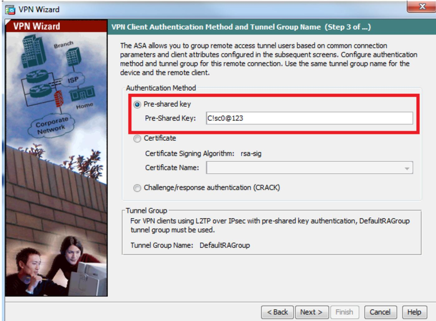
Stap 5. Specificeer een methode om gebruikers die L2TP via IPsec-verbindingen proberen te authenticeren. Ofwel kan een externe AAA-verificatieserver of zijn eigen lokale database worden gebruikt. Kies **Authenticate aan het gebruik van de lokale gebruikersdatabase** als u de clients wilt authenticeren tegen de lokale database van ASA en klik op **Volgende**.
