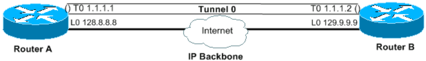
Afbeelding 1 - Voorbeeld van het Keeplevingsmechanisme van de Tunnel
