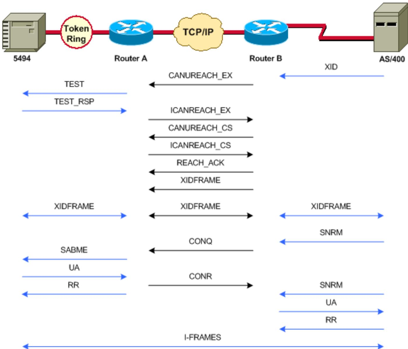
Een andere algemene instelling wordt reverse-Synchronous Data Link Control (SDLC) Logical Link Control (LLC) genoemd; SDLLC, wat is wanneer het primaire station aan de router door een SDLC-lijn is bevestigd. Dit wordt meestal gezien in host omgevingen die de host naar een Token Ring-bijlage migreren. Deze instelling verandert de manier waarop DLSw de SDLC-lijn verwerkt, omdat er meestal een hoge mate van onzekerheid is over de vraag of de externe PU actief is of niet.
