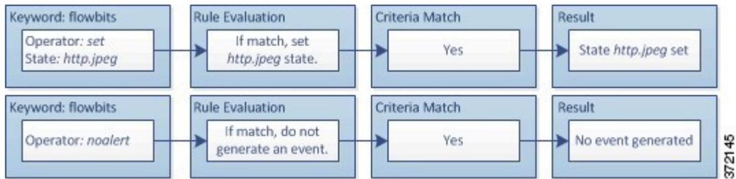
첫 번째 규칙 프래그먼트의 content 및 pcre 키워드는 JPEG 파일 다운로드를 매칭하고, flowbits:set,http.jpeg는 http.jpeg flowbits 상태를 설정하며, flowbits:noalert는 규칙의 이벤트 생성을 중지합니다. 규칙의 목적은 파일 다운로드를 탐지하고 flowbits 상태를 설정하는 것이며 하나 이상의 동반 규칙이 악성 콘텐츠와 조합된 상태 이름을 테스트하여 악성 콘텐츠가 탐지되면 이벤트를 생성할 수 있도록 하는 것이므로 어떤 이벤트도 생성되지 않습니다.
