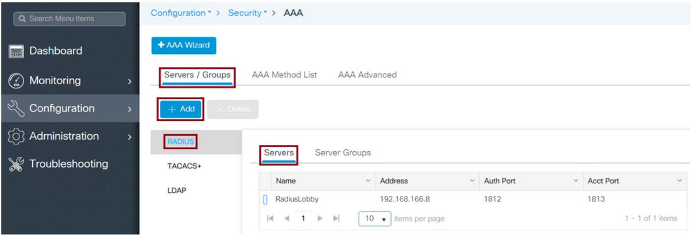
컨피그레이션 창이 열리면 필수 컨피그레이션 매개변수는 RADIUS 서버 이름(ISE/AAA 시스템 이름과 일치하지 않아도 됨), RADIUS 서버 IP 주소 및 공유 비밀입니다. 다른 매개변수는 기본값으로 남겨두거나 원하는 대로 구성할 수 있습니다.
