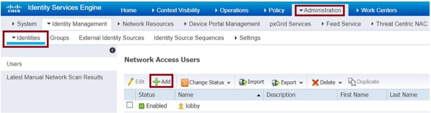
구성 창이 열리면 로비 앰버서더 사용자의 이름과 암호를 입력합니다.또한 Status(상태)가 Enabled(활성화됨)인지 확인합니다.
