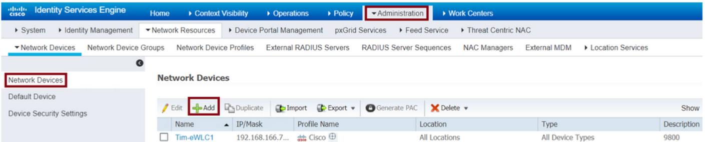
구성 창이 열리면 이름, IP ADD, enable RADIUS Authentication Settings(IP 추가, RADIUS 인증 설정 활성화)를 제공하고 Protocol Radius(프로토콜 반경)에 필요한 공유 암호를 입력합니다.
