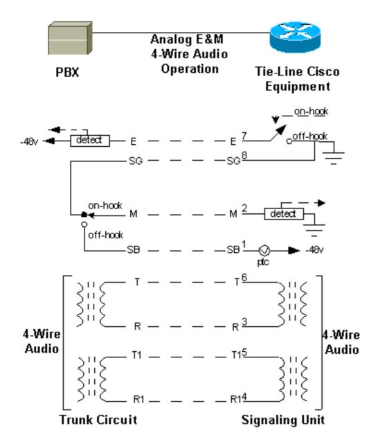
참고: 4선 오디오 설정의 경우 라우터의 핀 6(팁) 및 3(링)은 PBX에서 라우터로 오디오 경로를 전송합니다.라우터의 핀 5(Tip1) 및 4(Ring1)는 라우터에서 PBX로 오디오 경로를 전송합니다.
