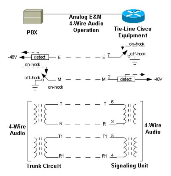
참고: 4선 오디오 설정의 경우 라우터의 핀 6(팁) 및 3(링)이 PBX에서 라우터로 오디오 경로를 전송합니다.라우터의 핀 5(Tip1) 및 4(Ring1)는 라우터에서 PBX로 오디오 경로를 전송합니다.
