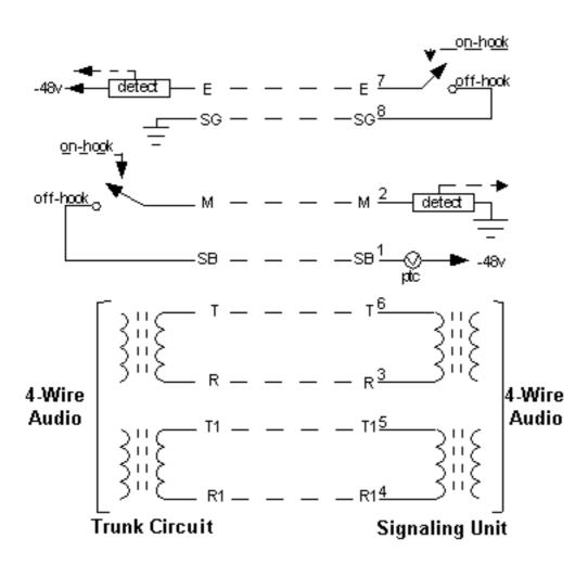
참고: 4선 오디오 설정의 경우 라우터의 핀 6(팁) 및 3(링)은 PBX에서 라우터로 오디오 경로를 전송합니다.라우터의 핀 5(Tip1) 및 4(Ring1)는 라우터에서 PBX로 오디오 경로를 전송합니다.
