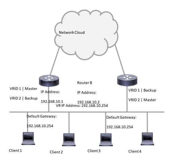
가상 라우터 2의 경우 라우터 B는 IP 주소 192.168.10.2 및 가상 활성 라우터의 소유자이며 라우터 A는 라우터 B에 대한 가상 라우터입니다. 클라이언트 3과 4는 기본 게이트웨이 IP 주소 192.168.10.254으로 구성됩니다.
