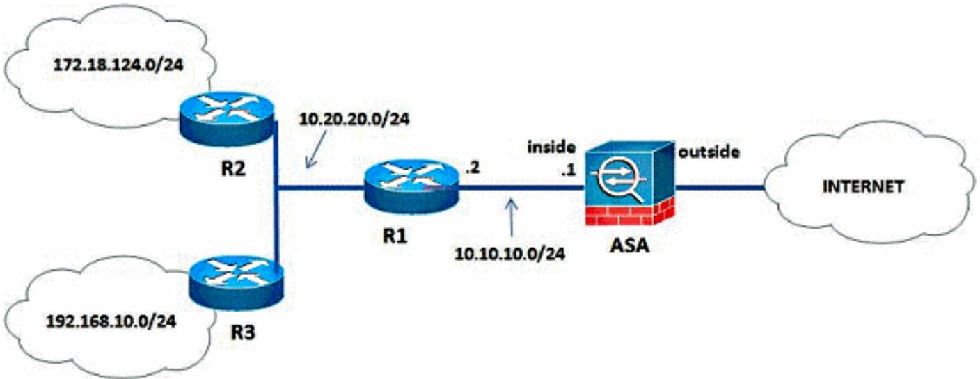
표시된 네트워크 토폴로지에서 Cisco ASA 내부 인터페이스 IP 주소는 10.10.10.1/24입니다. 목표는 인접 라우터(R1)를 통해 동적으로 내부 네트워크 경로(10.20.20.0/24, 172.18.124.0/24 및 192.168.10.0/24)를 학습하기 위해 Cisco ASA에서 EIGRP를 구성하는 것입니다. R1은 다른 두 라우터(R2 및 R3)를 통해 원격 내부 네트워크에 대한 경로를 학습합니다.
