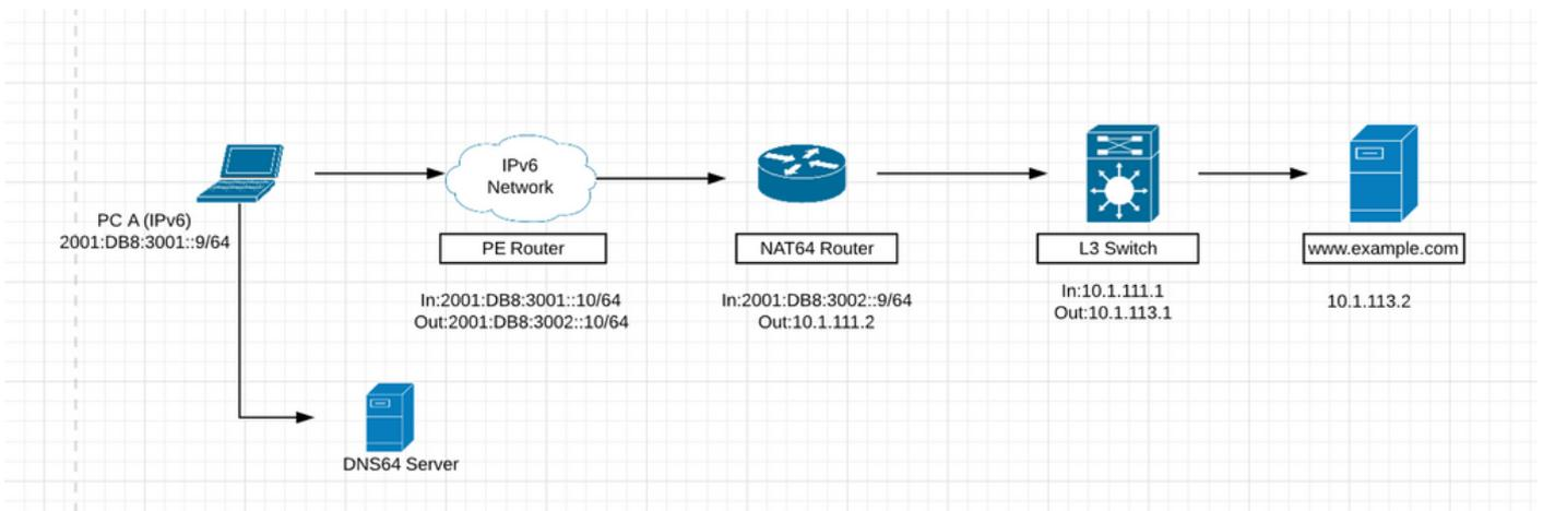
1단계. 호스트 A는 서버 www.example.com과 통신하려는 IPv6 전용 호스트입니다.이렇게 하면 DNS 쿼리(AAAA:www.example.com)를 DNS64 서버에 연결합니다.DNS64는 이 프로세스의 핵심 구성 요소입니다.DNS64 서버는 IPv6 및 IPv4용 DNS 서버입니다. IPv6 주소를 사용하여 IPv4 서버에 연결할 수 있다는 환상을 클라이언트에 부여합니다.
