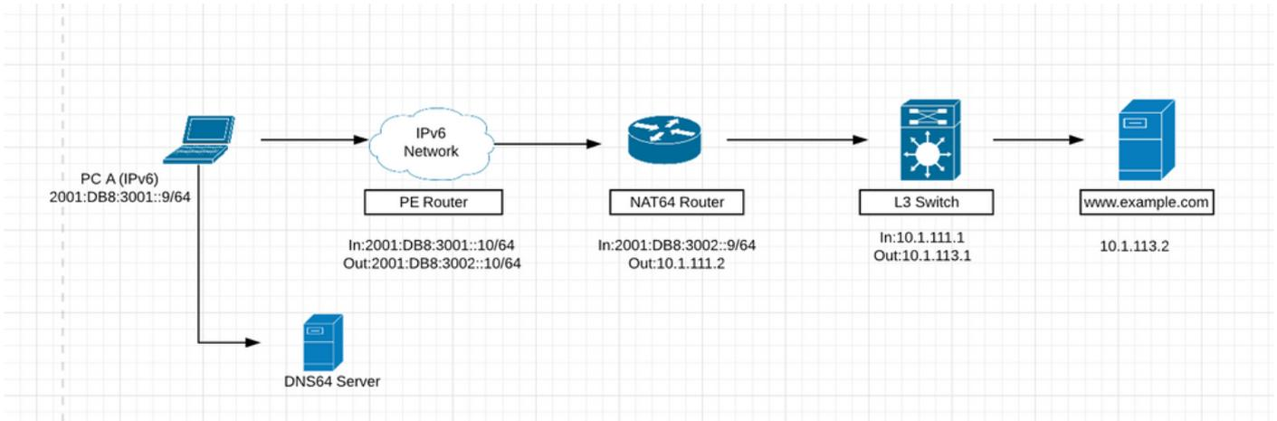
1. IPv6 네트워크에 있는 위의 그림 호스트에서 IPv4 전용 서버인 웹 서버 [www.example.com](http://www.example.com)(10.1.113.2)와 통신하려고 한다고 가정합니다.
