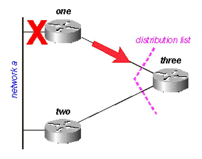
그림 16a Router 3은 경로를 도달 불가로 표시한 다음 Router 2를 쿼리합니다.
