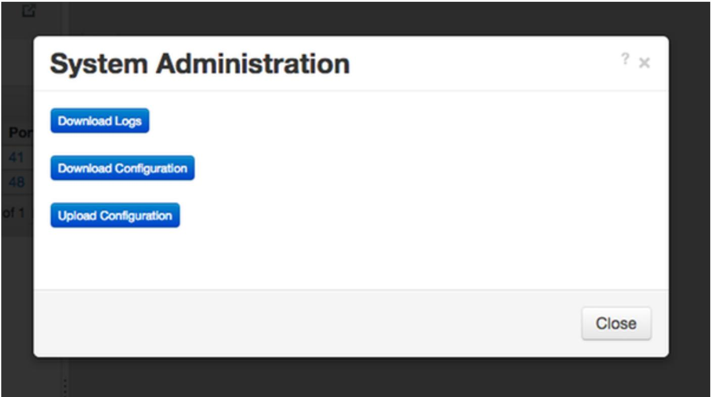
옵션을 선택하면 선택한 항목이 로컬로 다운로드되고 팝업 창이 닫힙니다. Nexus Data Broker 컨텍스트로 돌아가려면 창 상단의 **Nexus Data Broker** 버튼을 클릭합니다.
