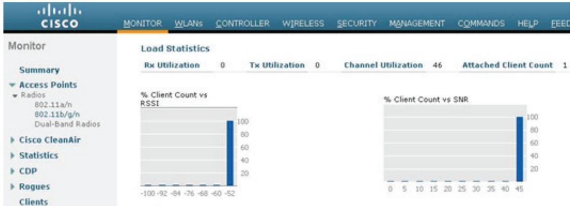
Cisco Unified Wireless Network をインストールする前に、チャンネル干渉および、AirMagnet や Wild Packets、Cognio などのツールの使用に関して、サイトをテストする必要があります。設計プロセスを支援するために、Cisco Prime Infrastructure によって生成される AP オンデマンド統計レポートは、次のスペクトルの確認を提供します。
