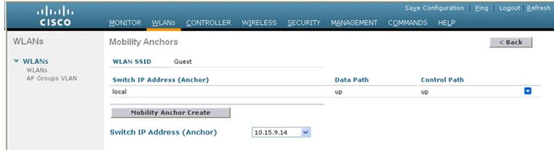
ゲスト WLAN のモビリティ アンカーはアンカー WLC 自体なので、データとコントロールパスのステータスは常に「up」と表示されます。「up」と表示されない場合、ローカル WLC をアンカーとして [Switch IP Address (Anchor)] ドロップダウンメニューから選択したことを確認します。
