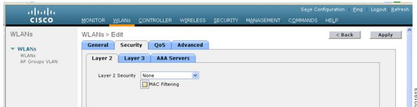
上記の設定では、セキュリティ ポリシーを使用せずに WLAN が設定されます。ゲストトラフィックは、アンカー コントローラを通過して、Cisco NAC Appliance の inside インターフェイスまたは信頼されていないインターフェイスに到達し、ユーザが認証されるまでブロックされます。
