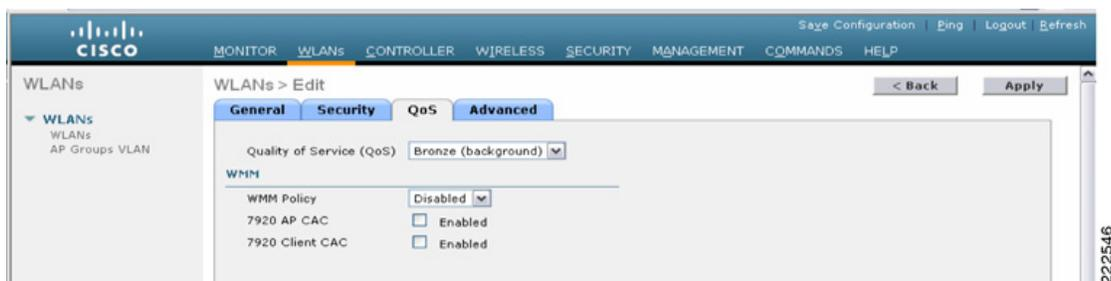
**ステップ 9** オプションで、ゲスト WLAN にアップストリーム QoS プロファイルを設定します。デフォルトは「Silver (Best Effort)」です。この例では、ゲスト WLAN は最低の QoS クラスに再割り当てされています。
