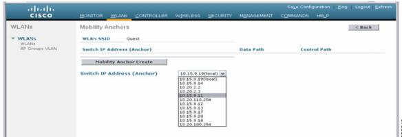
図 10-26 WLAN モビリティ アンカーの選択
