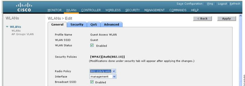
ステップ 4 レイヤ 2 セキュリティを、デフォルトの設定 (802.1x WPA/WPA2) から [none] に設定します (図 10-20 を参照)。
