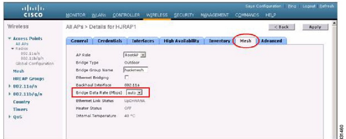
図 8: 自動に設定されたブリッジレート
