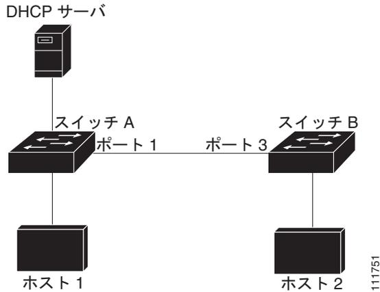
実際には信頼できないインターフェイスを信頼できるインターフェイスとして設定すると、ネットワーク内にセキュリティホールが生じます。スイッチ A でダイナミック ARP インспекションが実行されていない場合、ホスト 1 はスイッチ B の ARP キャッシュを簡単にポイズニングできます（および、これらのスイッチの間のリンクが信頼できるものとして設定されている場合はホスト 2）。この状況は、スイッチ B がダイナミック ARP インспекションを実行している場合でも発生します。
