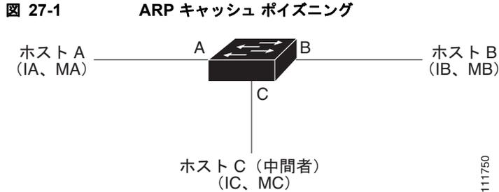
ホスト A、B、および C は、インターフェイス A、B、および C 上にあるスイッチに接続されています。これらはすべて同一のサブネット上にあります。カッコ内に示されているのは、これらの IP アドレス、および MAC アドレスです。たとえば、ホスト A が使用する IP アドレスは IA、MAC アドレスは MA です。ホスト A が IP レイヤにあるホスト B と通信する必要がある場合、ホスト A は IP アドレス IB と関連付けられている MAC アドレスに ARP 要求をブロードキャストします。スイッチとホスト B は、この ARP 要求を受信すると、IP アドレスが IA で、MAC アドレスが MA のホストに対する ARP バインディングを ARP キャッシュに読み込みます。たとえば、IP アドレス IA は、MAC アドレス MA にバインドされています。ホスト B が応答すると、スイッチ、およびホスト A は、IP アドレスが IB で、MAC アドレスが MB のホストに対するバインディングを ARP に読み込みます。
