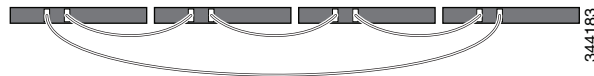
図 2-2 横に並べて設置した最大 4 台のスイッチによるデータスタック
