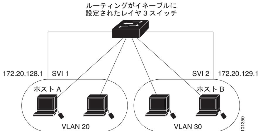
LAN Base イメージでは、基本的なルーティング (スタティック ルーティングと RIP) がサポートされます。高いパフォーマンスを維持するため、可能な場合は常にスイッチ ハードウェアによって転送を行います。ただし、ハードウェア内をルーティングできるのは、イーサネット II カプセル化機能を備えた IP バージョン 4 パケットだけです。非 IP トラフィックと、他のカプセル化方式を使用しているトラフィックは、ハードウェアによってフォールバック ブリッジングできます。
