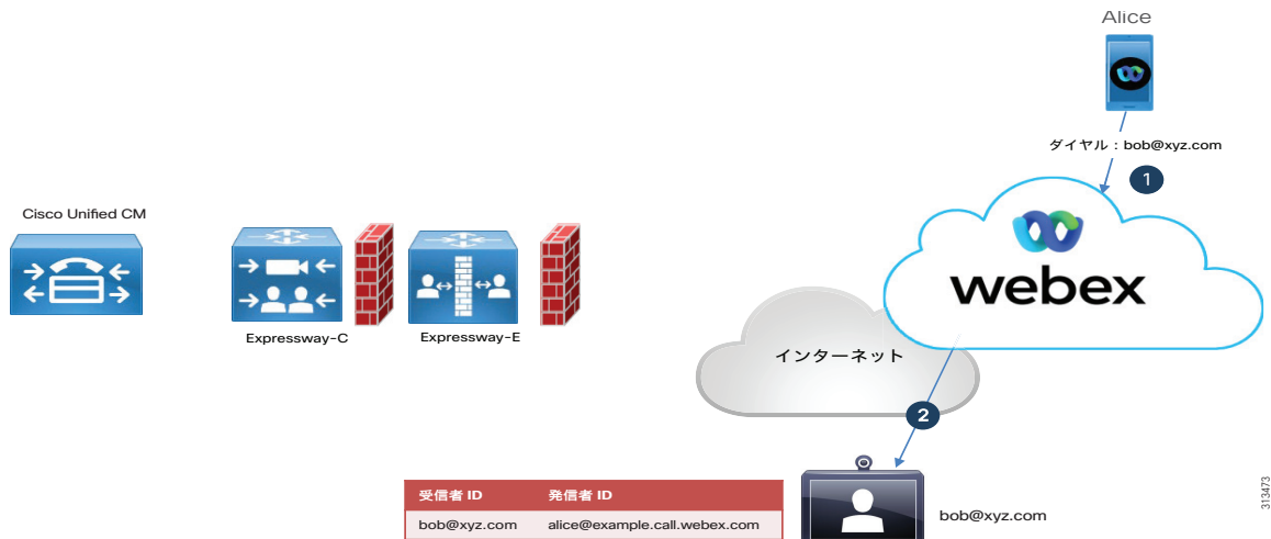
C : 図 4-6 選択したドメインのみが Cisco Unified CM を経由してルーティングされる
