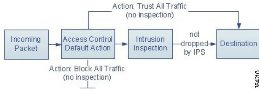
インライン展開された ASA FirePOWER モジュールだけがトラフィックのフローに影響を与える可能性があることに注意してください。トラフィックをブロックまたは変更するように設定されたアクセスコントロールポリシーをパッシブに展開されたデバイスに適用すると、予期しない結果になることがあります。場合によっては、パッシブに展開された ASA FirePOWER モジュールへのインライン設定の適用がシステムにより阻止されることがあります。
