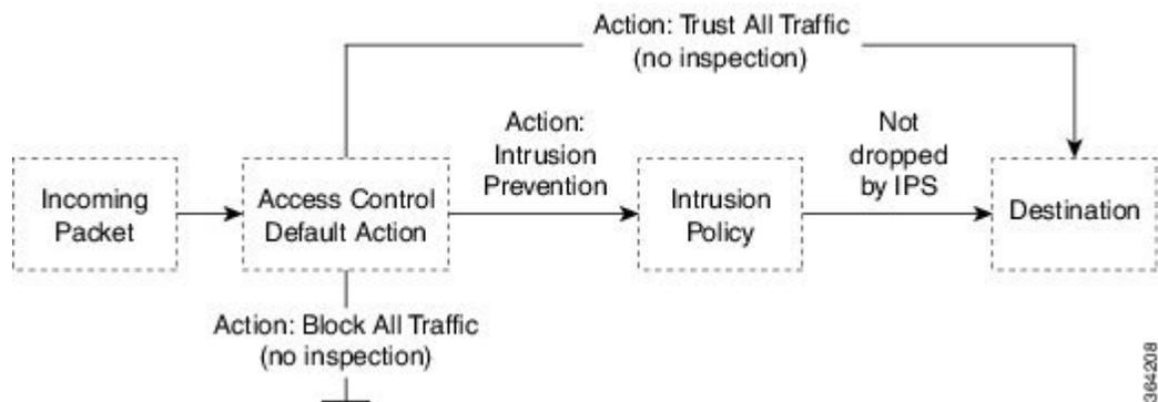
次の表に、さまざまなデフォルトアクションがトラフィックを処理する方法を示し、各デフォルトアクションで処理されるトラフィックで実行できるインスペクションのタイプを示します。デフォルトアクションで処理されるトラフィックでは、ファイルまたはマルウェアのイン
