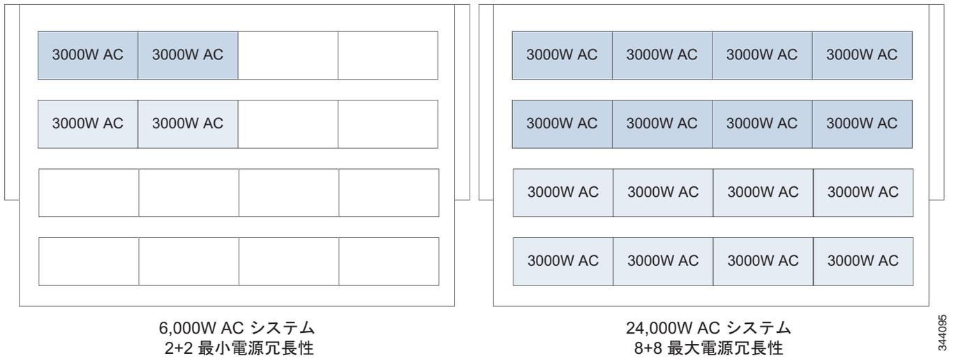
図 3-5 Cisco ASR 9912 ルータの AC システム電源冗長性 : バージョン 2
