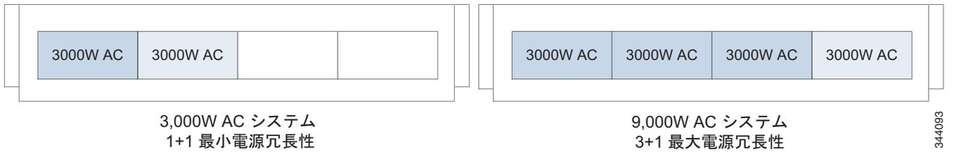
図 3-4 Cisco ASR 9922 ルータの AC システム電源の冗長性 : バージョン 2
