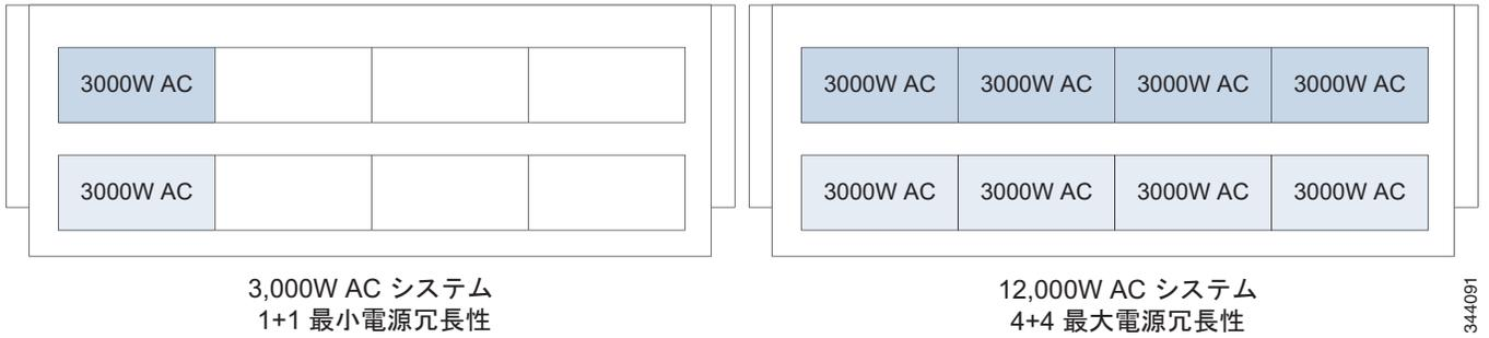
図 3-3 Cisco ASR 9006 ルータの AC システム電源の冗長性 : バージョン 2
