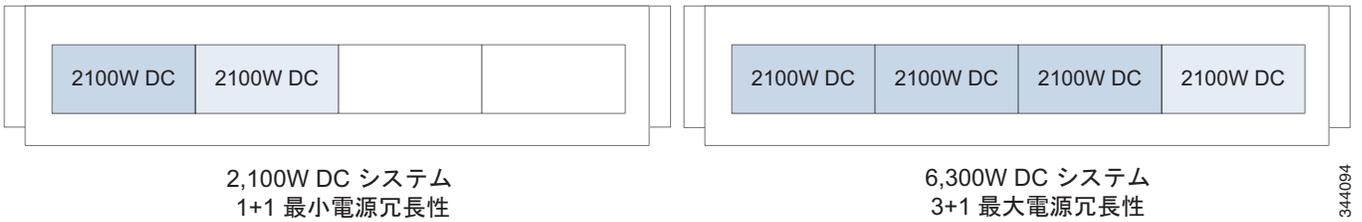
図 3-9 Cisco ASR 9922 ルータの DC システム電源の冗長性 : バージョン 2
