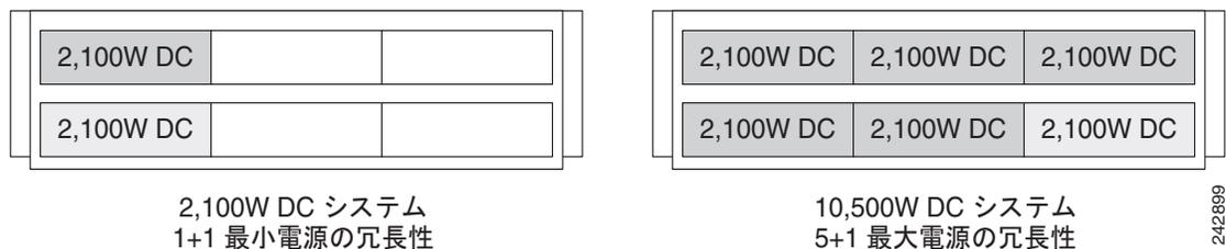
図 3-7 Cisco ASR 9010 ルータの DC システム電源の冗長性 : バージョン 2
