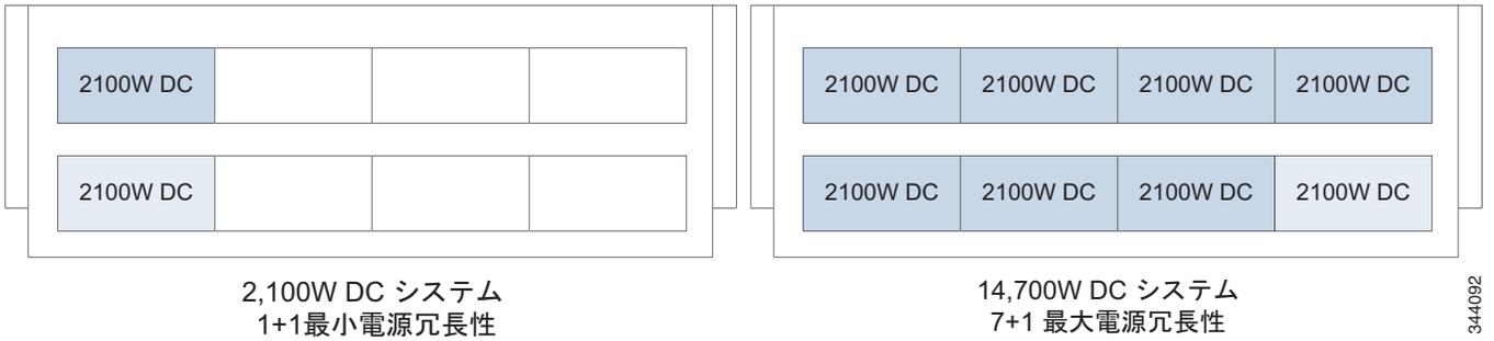
図 3-8 Cisco ASR 9006 ルータの DC システム電源の冗長性 : バージョン 2
