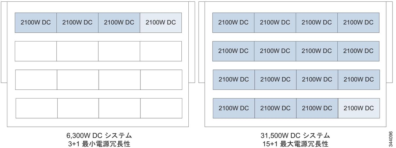
図 3-10 Cisco ASR 9912 ルータの DC システム電源冗長性：バージョン 2
