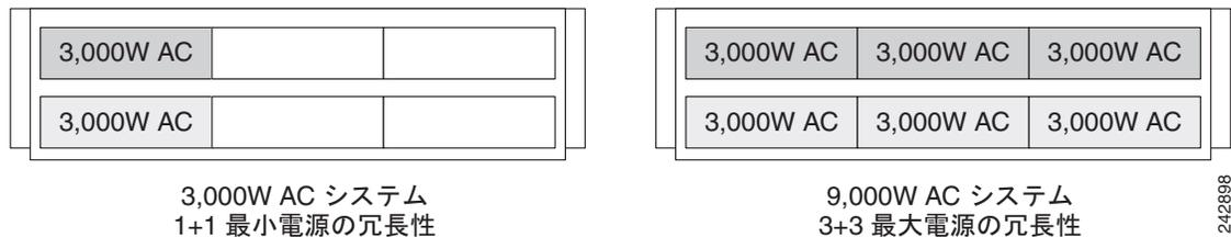
図 3-2 Cisco ASR 9010 ルータの AC システム電源の冗長性 : バージョン 2
