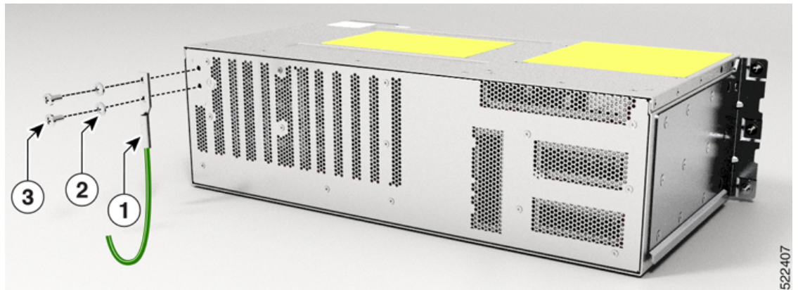
図 9: シャーシの背面へのアースラグの固定
