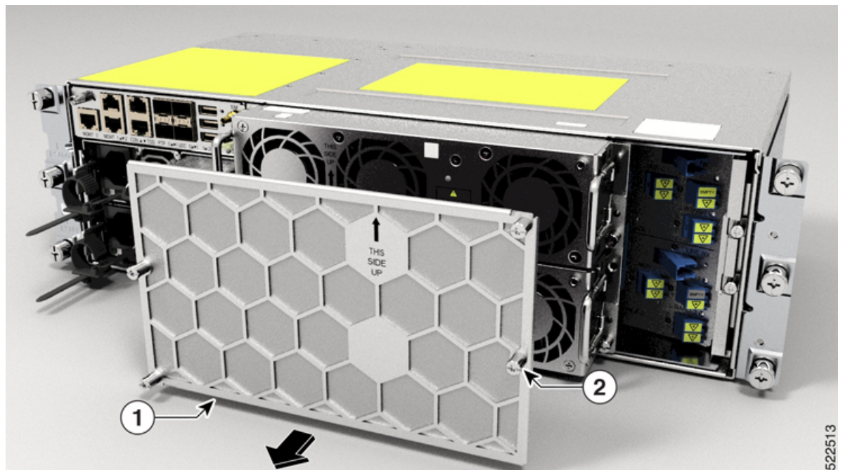
図 83: ファンフィルタの取り外し
