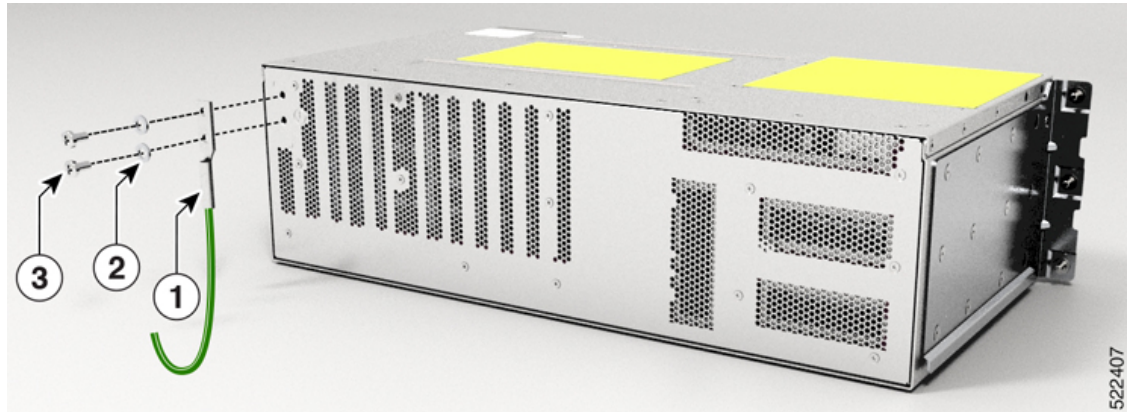
図 63: シャーシの背面へのアースラグの固定
