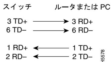
図 1-9 に、イーサネット クロス ケーブルの結線図を示します。クロス ケーブルはスイッチやハブに接続するときに使用します。
