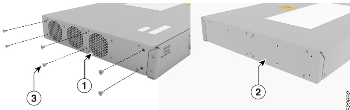
図 38: シャーシの側面からネジを取り外す
