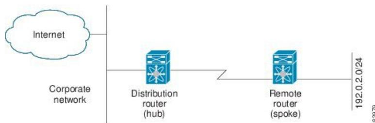
スタブ ルーティングを使用する場合でも、リモートルータにルータをアドバタイズできます。この単純なハブ アンド スポーク ネットワークの図は、リモートルータが、分散ルータを介してのみ、企業ネットワークとインターネットにアクセスできることを示しています。この例では、企業ネットワークとインターネットへのパスが常に分散ルータを経由するため、リモートルータ上の完全なルート テーブルの機能は無意味です。より大規模なルート テーブルを使用しても、リモートルータに必要なメモリの量が削減されるだけです。使用される帯域幅とメモリは、分散ルータでルートを要約し、フィルタリングすると、削減できます。このネットワーク トポロジでリモートルータは、他のネットワークから検出されたルートを受信する必要はありません。これは、宛先がどこであっても、リモートルータは、すべての非ローカルトラフィックを分散ルータに送信する必要があるためです。真のスタブ ネットワークを設定するには、リモートルータへのデフォルト ルートのみを送信するよう、分散ルータを設定する必要があります。
