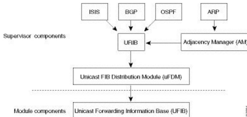
ユニキャスト RIB はアクティブなスーパーバイザ上にあります。ユニキャスト RIB は、直接接続のルート、スタティックルート、ダイナミックユニキャストルーティングプロトコルで検出されたルートを含むルーティングテーブルを維持しています。また、アドレス解決プロトコル（ARP）などの送信元から、隣接情報を収集します。ユニキャスト RIB は、特定のルートのための最適なネクストホップを決定し、ユニキャスト FIB 分散モジュール（FDM）のサービスを使用して、FIB にデータを入力します。
