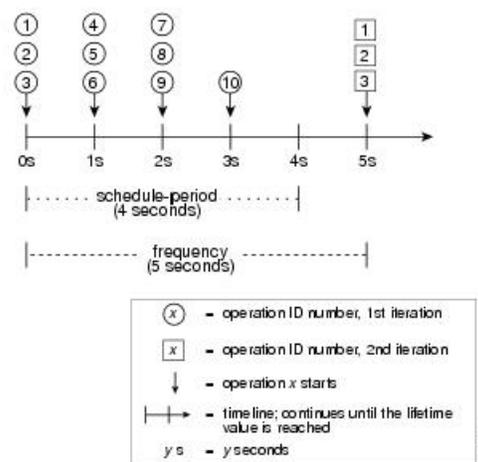
この例では、IP SLA 複数動作スケジューリング機能が、動作の数をスケジュール期間で割ることにより、各1秒間隔で開始しなければならない動作の数を計算します（10個の動作が4秒で割られて、1秒毎に2.5動作になる）。動作の数は1秒間隔では均等に分割できないため、この数は切り上げられ、残った動作は最後の1秒間隔に開始されることとなります（図を参照）。
