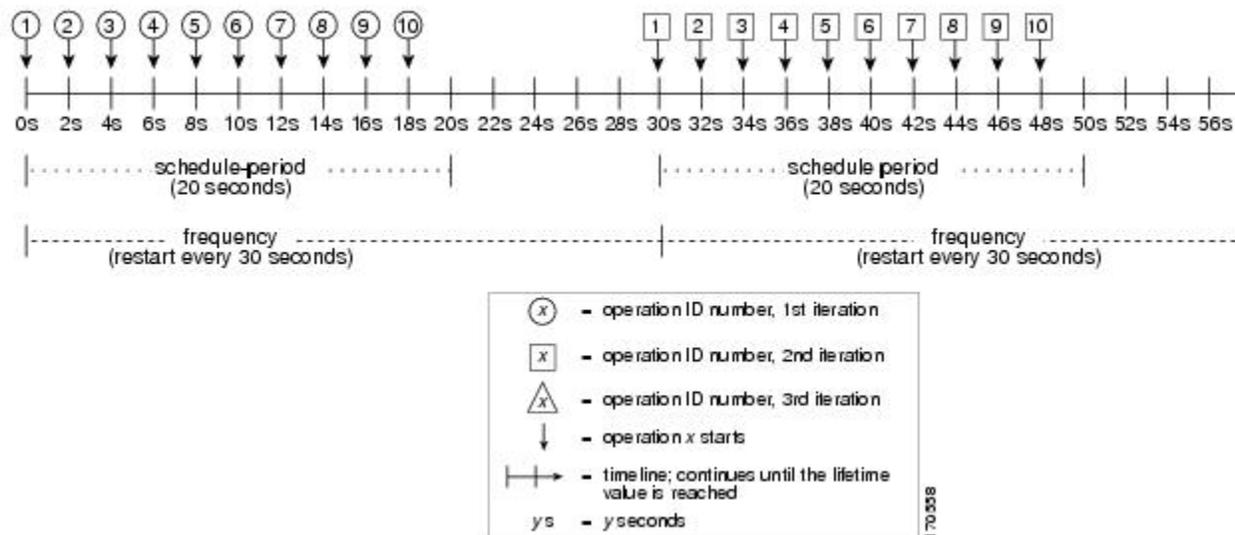
この例では、動作グループ2内の最初の動作（動作1）が0秒に開始します。動作グループ2内の10個すべての動作（動作1～10）が、20秒のスケジュール期間内に開始される必要があります。各 IP SLA 動作の開始時間は、スケジュール期間を動作の数で割ることにより（20秒が10個の動作で割られる）、スケジュール期間にわたって均等に分散されます。したがって、各動作は前の動作の2秒後に開始されます。
