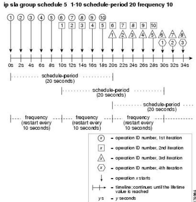
この例では、動作グループ 5 内の最初の動作（動作 1）が 0 秒に開始します。動作グループ 5 内の 10 個すべての動作（動作 1～10）が、20 秒のスケジュール期間内に開始される必要があります。各 IP SLA 動作の開始時間は、スケジュール期間を動作の数で割ることにより（20 秒が 10 個の動作で割られる）、スケジュール期間にわたって均等に分散されます。したがって、各動作は前の動作の 2 秒後に開始されます。
