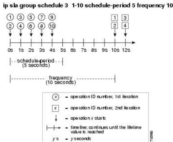
この例では、スケジュール期間を動作の数で割ると、各 IP SLA 動作の開始時間が 1 秒未満になります（5 秒を 10 個の動作で割ると、0.5 秒毎に 1 動作になる）。グループ動作内の IP SLA 動作の開始の最小間隔は 1 秒なので、IP SLA 複数動作スケジューリング機能は、動作の数を
