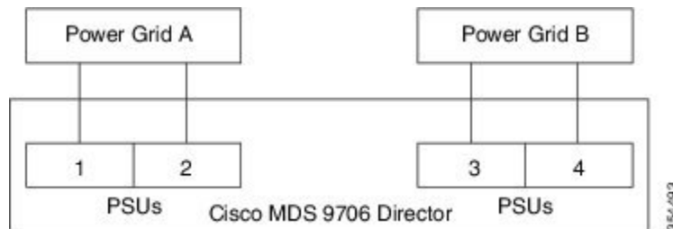
図 3: Cisco MDS 9706 グリッド PSU 接続
