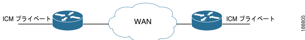
図 2-11 Unified ICM のプライベート トラフィック用の独立した WAN リンク
