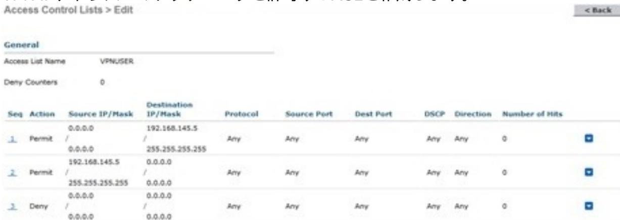
2. ACLを事前認証ACLとして、レイヤ3セキュリティのワイヤレスLAN(WLAN)設定に適用します。
