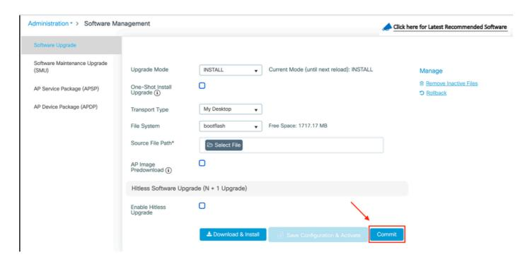
APは、コントローラに再び到達できることを検出すると、バックアップパーティションでのリロードを開始し、新しいバージョンで稼働しているコントローラに加入します。
