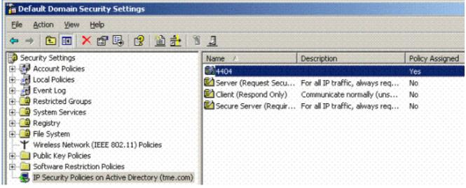
5. 新しい4404ポリシーのプロパティを編集し、[Rules] タブをクリックします。新しいフィルタルールを追加します(IPフィレットリスト(ダイナミック)、フィルタアクション(デフォルト応答)、認証(PSK)、トンネル(なし))。新しく作成したフィルタルールをダブルクリックし、[Security Methods]を選択します。
