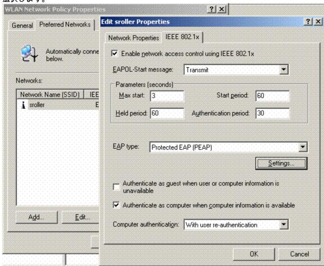
3. [PEAP Settings] をクリックし、[Validate server certificate] にチェックマークを入れて、 [Trusted Root Cert installed on Certificate Authority]を選択します。テスト目的で、 [Automatically use my Windows login and password]の[MS CHAP v2]ボックスをオフにします。
