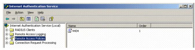
4. コントローラのリモートアクセスポリシーのプロパティを編集します。必ずNASポートタイプ – Wireless - IEEE 802.11を追加します。
