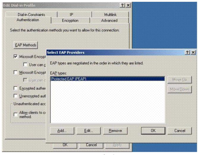
7. [Select EAP Providers]で[Edit] をクリックし、プルダウンメニューからActive DirectoryユーザアカウントとCAに関連付けられたサーバ(tme.tme.comなど)を選択します。EAPタイプMSCHAP v2を追加します。
