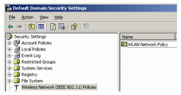
2. [WLAN Network Policy Properties]を開き、[Preferred Networks] をクリックします。新しい優先WLANを追加し、WLAN SSIDの名前(Wirelessなど)を入力します。新しい優先ネットワークをダブルクリックし、[IEEE 802.1x]タブをクリックします。EAPタイプとしてPEAPを選択します。
