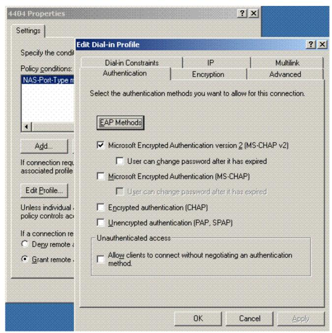
6. [EAP Methods] をクリックし、[EAP Providers]を選択して、EAPタイプとしてPEAPを追加します。
