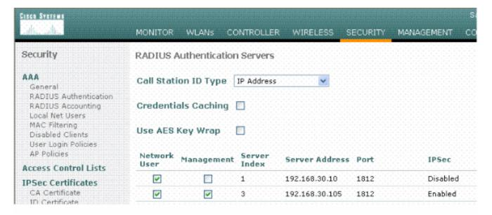
2. 新しいRADIUSサーバのIPアドレス、ポート1812、および共有秘密を設定します。[IPSec Enable] チェックボックスをオンにして、これらのIPSecパラメータを設定し、[Apply] をクリックします。注:共有秘密は、RADIUSサーバの認証と、IPSec認証用の事前共有キー (PSK)の両方に使用されます。
