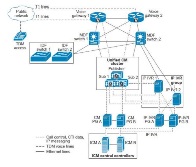
ICM Server または ICM Central Controller は単一のサーバとして表されますが、実際には、Unified CCE エージェントのカウントとコールのボリュームに応じてサイズが設定されたサーバのセットです。 ICM Central Controller には、次の冗長性/デュプレックス サーバが含まれます。
