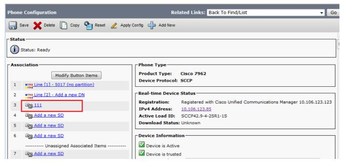
6. ポップアップウィンドウで[スピードダイヤル番号(Speed Dial Number)]と[表示テキスト (Display Text)]を設定します。
