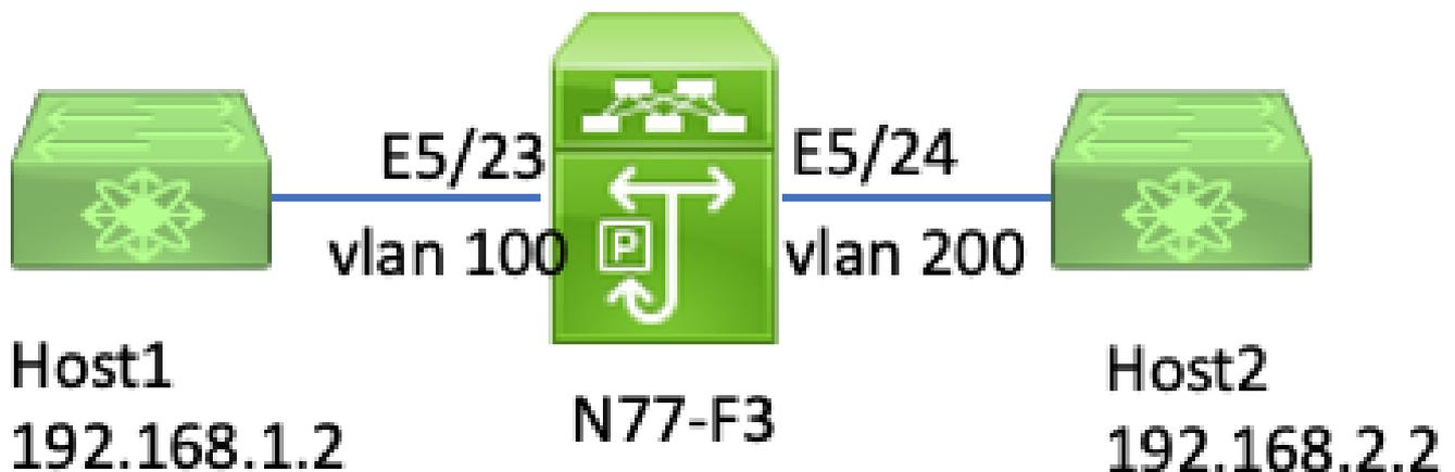
この例では、VLAN 100上のHost1(IPアドレス192.168.1.1/24、MACアドレス8c60.4fc7.c5bc)がポートE5/23に接続され、Internet Control Message Protocol(ICMP)要求をHost2に送信します。Host2のIPアドレスは192.168.2.2/24で、別のVLAN(VLAN200)にあります。
