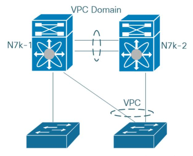
この例では、vPCインターフェイスがvPC対応VLANのみを伝送している場合、vPC孤立ポートトランクはvPC対応VLANとvPC非対応VLANの両方をトランクします。
