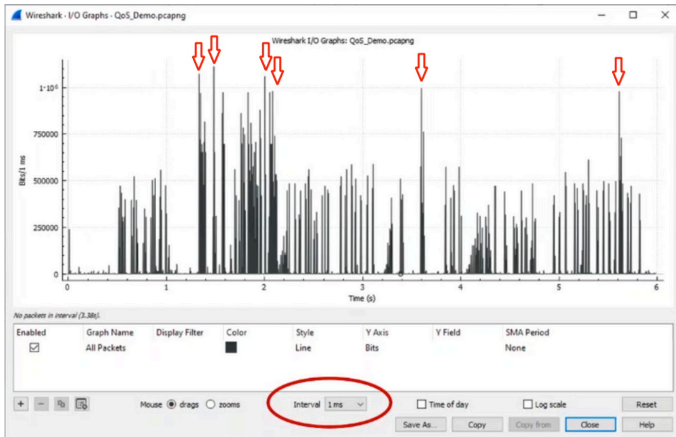
図 8.I/Oグラフで潜在的なマイクロバーストトラフィックを特定する方法を示します。
