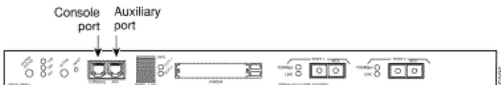
RJ-45 コネクタを備えた EIA/TIA-232 非同期シリアル ポートであるこのコンソール ポートは、ハードウェア フロー制御を備えたフル機能搭載の DTE 接続です。
