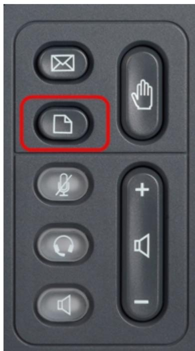
ステップ1:IP Phoneのセットアップボタンを押して、[情報と設定]メニューを表示します。
