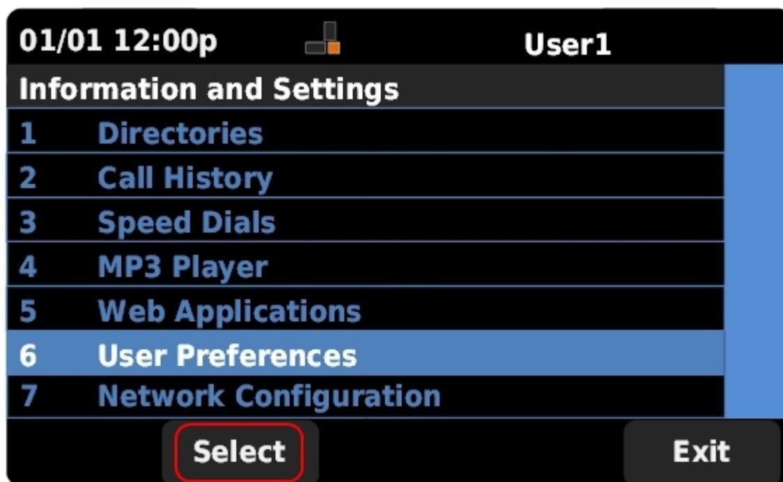
ステップ2：ナビゲーションキーを使用して上下にスクロールし、[ユーザー設定]を選択します。[選択]を押して、[ユーザー設定]メニューを開きます。
