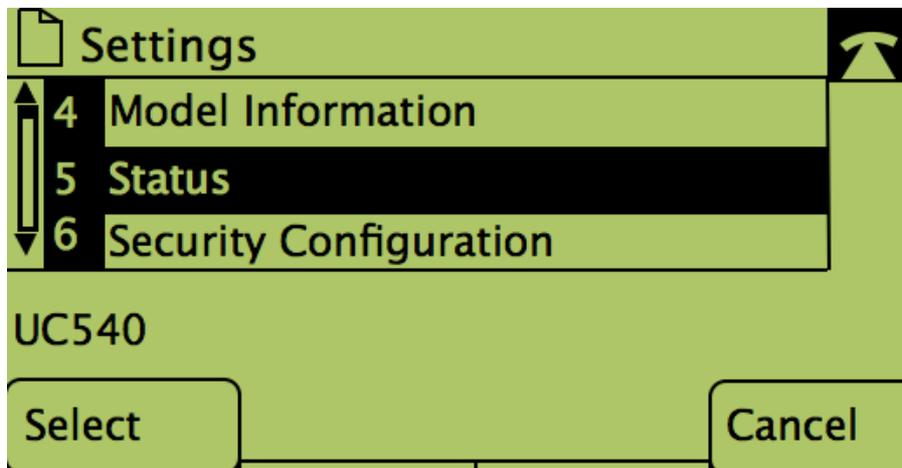
ステップ4：ソフトキーを押して、目的のステータスページに移動します。
