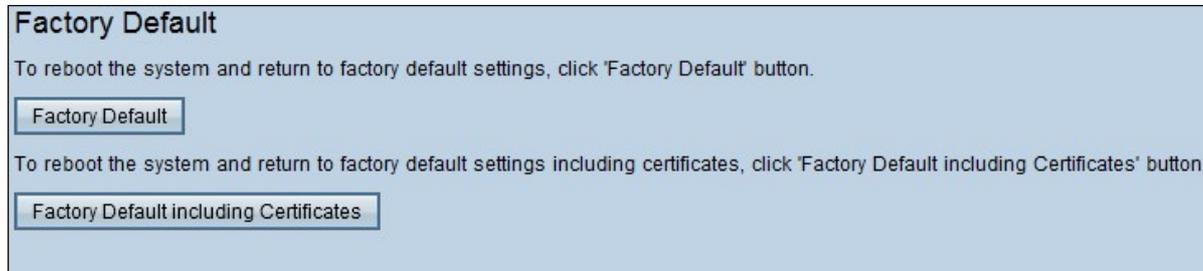
ステップ1:[Factory Default including Certificates]をクリックして、生成したすべての証明書を含むルータを工場出荷時のデフォルトに復元します。確認メッセージが表示されます。
