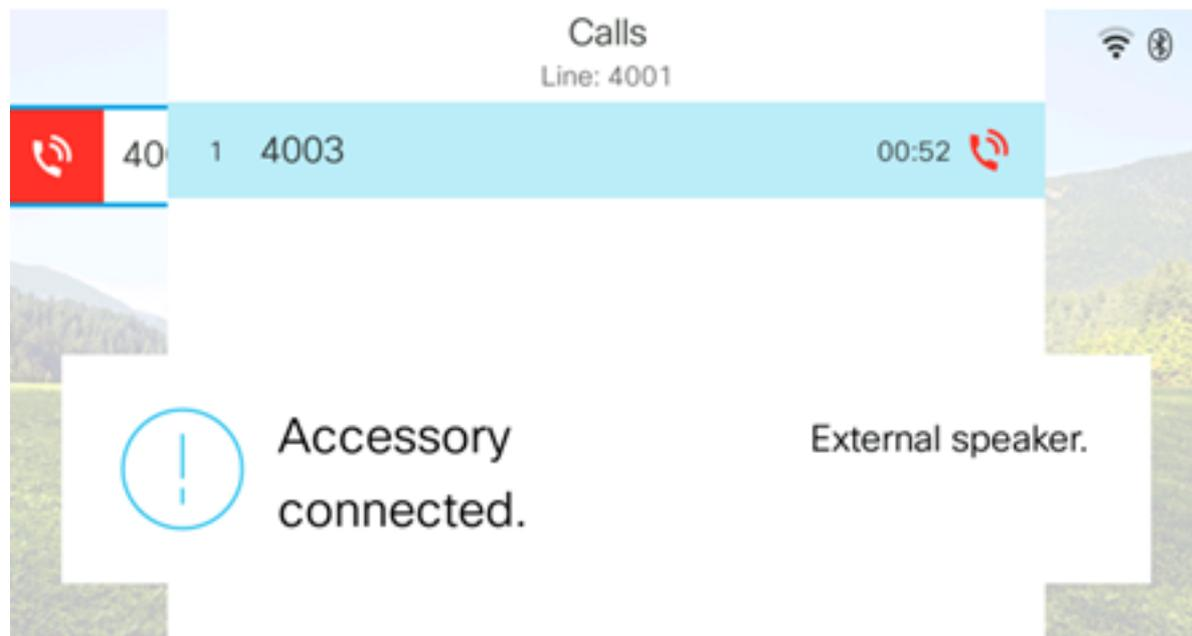
注：この例では、Plantronics VXI X100 V1.1ヘッドセットがCisco IP Phone 8861マルチプラットフォーム電話機のUSBポートに接続されています。ヘッドセットボタンがオレンジ色に点灯し、コールが外部スピーカからヘッドセットに転送されます。
