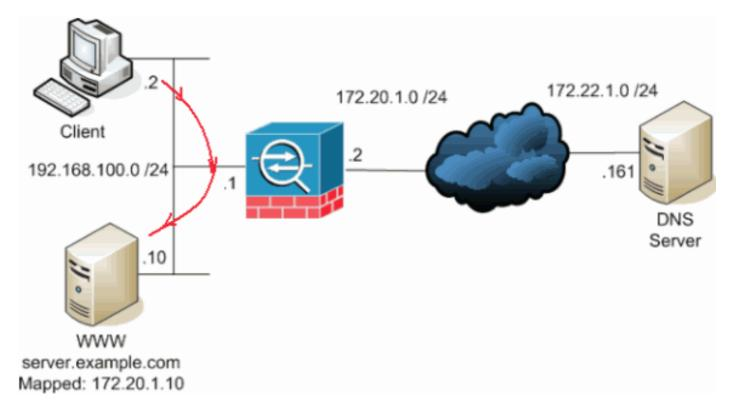
この場合、192.168.100.2 のクライアントが WWW サーバのパブリック アドレス(例: 172.20.1.10)を使用しようとしています。 クライアントのDNSサービスは、172.22.1.161の外部DNSサーバーによって提供されます。DNSサーバーは別のパブリックネットワーク上にあるため、WWWサーバーのプライベートIPアドレスを知りません。ただし、DNS サーバは WWW サーバのマップ アドレス(172.20.1.10)は認識しています。
