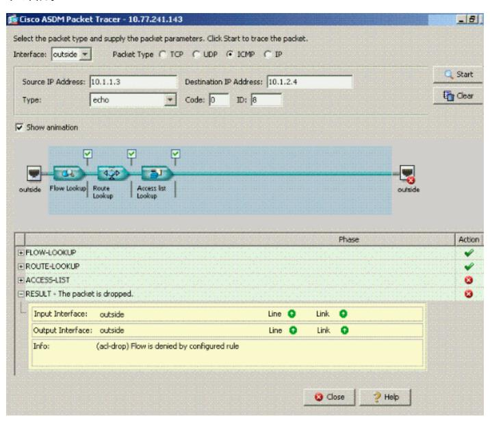
パケットトレーサの出力...は、デフォルトの構成設定がトラフィックをブロックしていることを示しています。管理者は、稼働中の設定を調べて、インターフェイス内通信がイネーブルになっていることを確認する必要があります。この場合、ASA 設定でインターフェイス内通信を有効にする必要があります(same-security-traffic permit intra-interface コマンド)。
