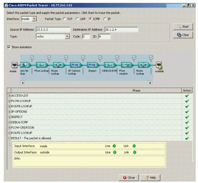
注:外部インターフェイスにはアクセスリストは適用されません。設定例では、Outside インターフェイスにはセキュリティ レベル 0 が割り当てられています。デフォルトでは、低セキュリティ インターフェイスから高セキュリティ インターフェイスへのトラフィックは、ファイアウォールでは許可されません。このため管理者は、外部(低セキュリティの)インターフェイスではアクセスリストによる許可がないと、インターフェイス内のトラフィックは許可されないと思い込んでしまう可能性があります。ところが、インターフェイスに適用されるアクセスリストがない場合は、同じインターフェイス トラフィックが制限なく渡されます。
