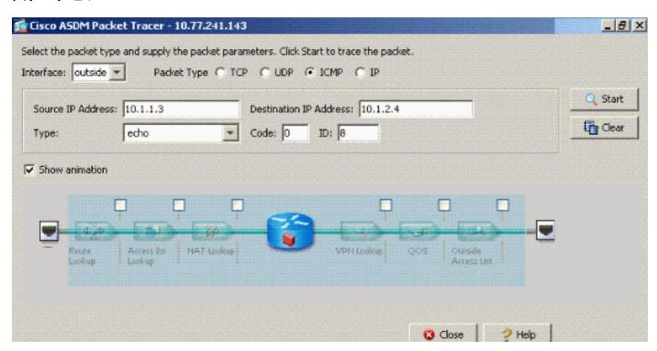
same-security-traffic permit intra-interface コマンドがイネーブルにされていて、インターフェイス内トラフィックが要求されている同じインターフェイスに access-list outside\_acl extended deny ip any any コマンドが設定されたパケットトレーサの出力。
