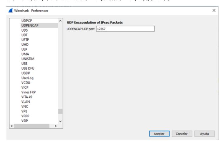
UDPENCAPが適切なポートに設定されると、図に示すようにESP情報が表示されます。
