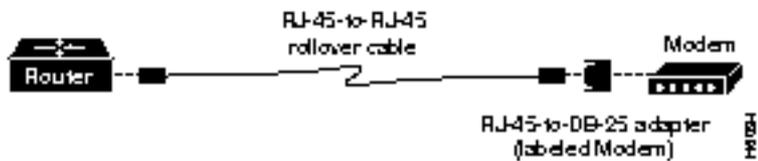
このアダプタの一方の端にはRJ-45コネクタが、もう一方の端にはオス型DB-25コネクタが付いています。
