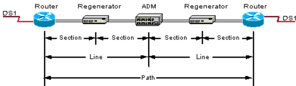
2 つのルータ POS インターフェイスを、高密度波長分割多重 (DWDM) リンクを通じて、中間 SONET や同期デジタル階層 (SDH) 機器を介さずにポイント ツー ポイントで接続する場合、3 つすべての BIP メカニズムは同じセグメントを監視し、通常は同じエラーを検出します。ただし、この構成では、B2 が最も正確なビットエラーカウントを示す必要があります。
